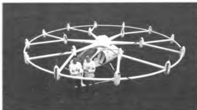
Углепластиковая рама сделана такой большой, чтобы обеспечить достаточное расстояние между винтами и избежать их негативного влияния друг на друга
